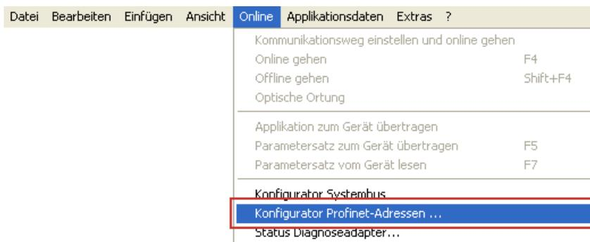
Das Dialogfenster **IP-Adressen vergeben** wird geöffnet und alle angeschlossenen Lenze PROFINET-Geräte werden aufgelistet.
