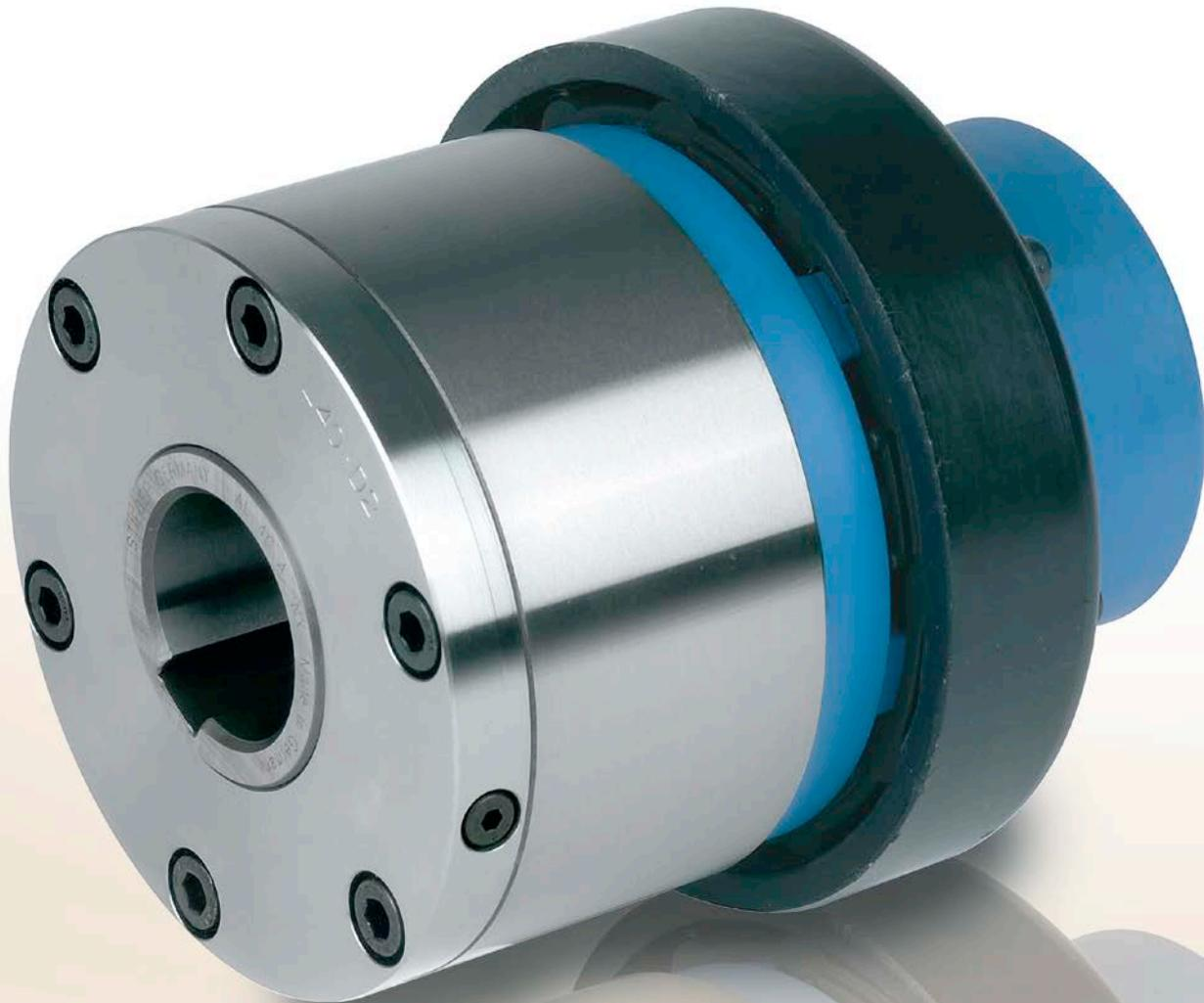
Die Bauart AL..KMSD2 ist ein abgedichteter, montagefertiger Rollenfreilauf, gelagert mit zwei Kugellagern der Reihe 160..
